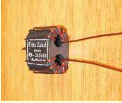
Bild 8: Zwei 20 cm lange Drähte 0,5 CuL werden durch je ein Loch des Doppellochkerens gesteckt und auf der einen Seite verdrillt.
