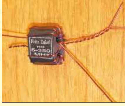
Bild 15: Das Ende des rechts hindurch- gesteckten Drahtes wird mit dem Ende des links aufge- wickelten langen Drahtes verdrillt.
