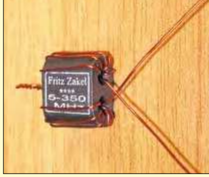
Bild 12: Die beiden langen Drahtenden legt man so, dass sie sich kreuzen.
