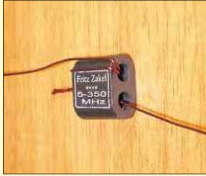
Bild 9: Der erste Draht wird mehrfach um das Loch gewickelt.
