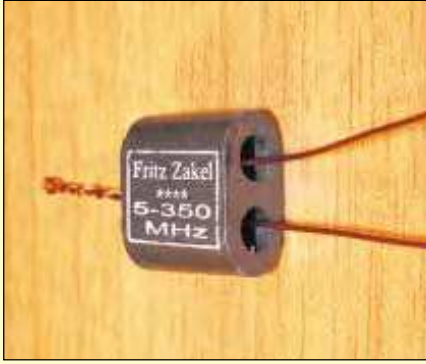
Bild 8: Zwei 20 cm lange Drähte 0,5 CuL werden durch je ein Loch des Doppellochkerens gesteckt und auf der einen Seite verdrillt.
