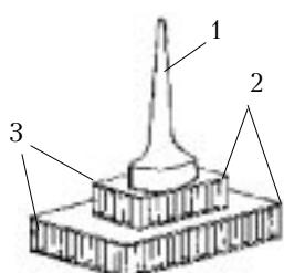
Рис. 1. Термоэлектрическая батарея с термозондом прибора для термоакupuncture: 1 — термозонд; 2 — тепловые переходы; 3 — термоэлементы
